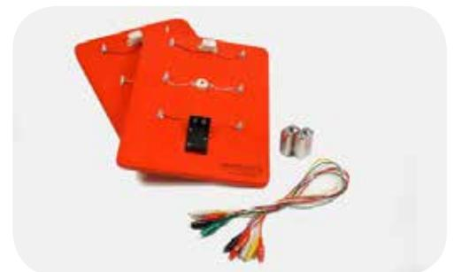
„Bei Dir piept es!“ Dann ist alles richtig! Hier kommt technisches Wissen auf den Prüfstand, indem man mit Kabeln einen Stromkreis legt. Nur bei korrekter Verkabelung ertönt ein Signalton.
